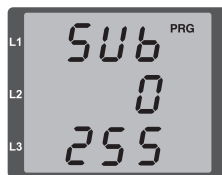
Fig. Subnet mask (SUB), Byte 0, value 255
